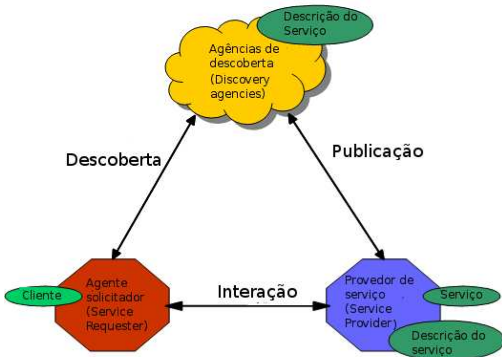
Figura 2 Diagrama de Arquitetura Orientada a Serviço (SOA) (adaptado BERNERS-LEE, 2002).
