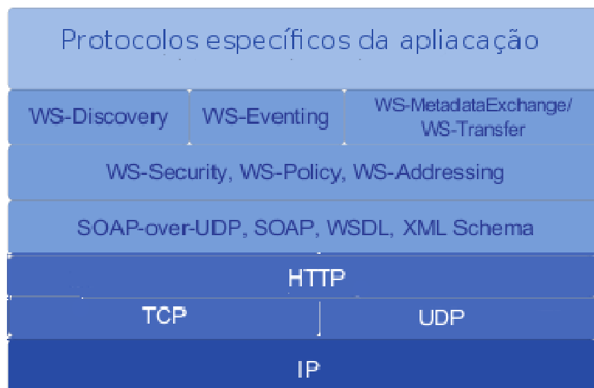
Figura 3 Diagrama de DPWS como uma pilha de protocolos (adaptado WS4D, Web Services For Devices).
