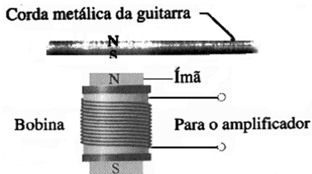
Figura 7: Funcionamento dos captadores magnéticos.
