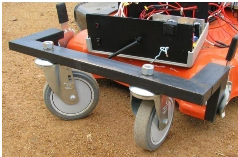
Fig. 4.18: Suporte metálico das rodas dianteiras.
