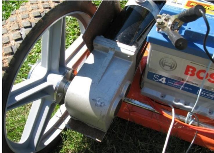
Fig. 4.17: Fixação do motor ao chassi
