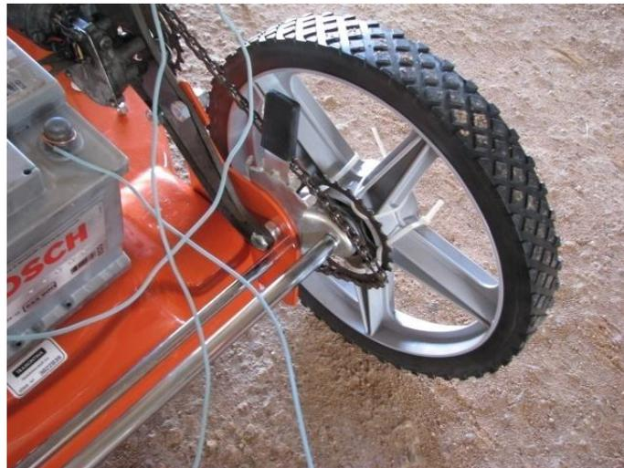
Fig. 4.14: Primeira tentativa de acoplamento do motor.
