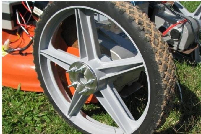
Fig. 4.16: Fixação da roda ao eixo do motor
