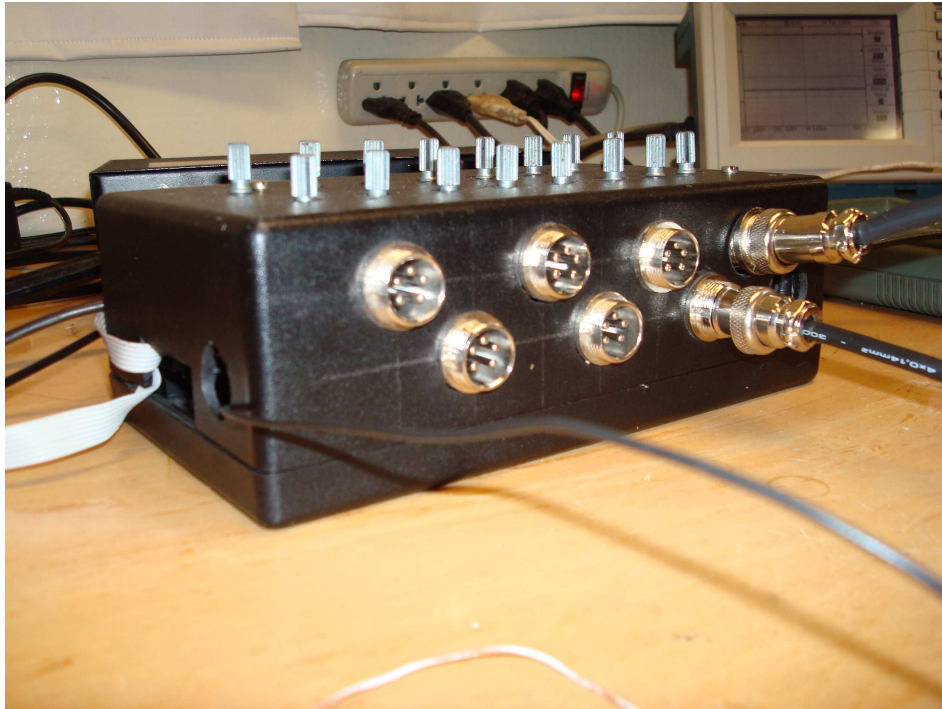
Figura 3.5: Eletromiógrafo desenvolvido no IEE.
