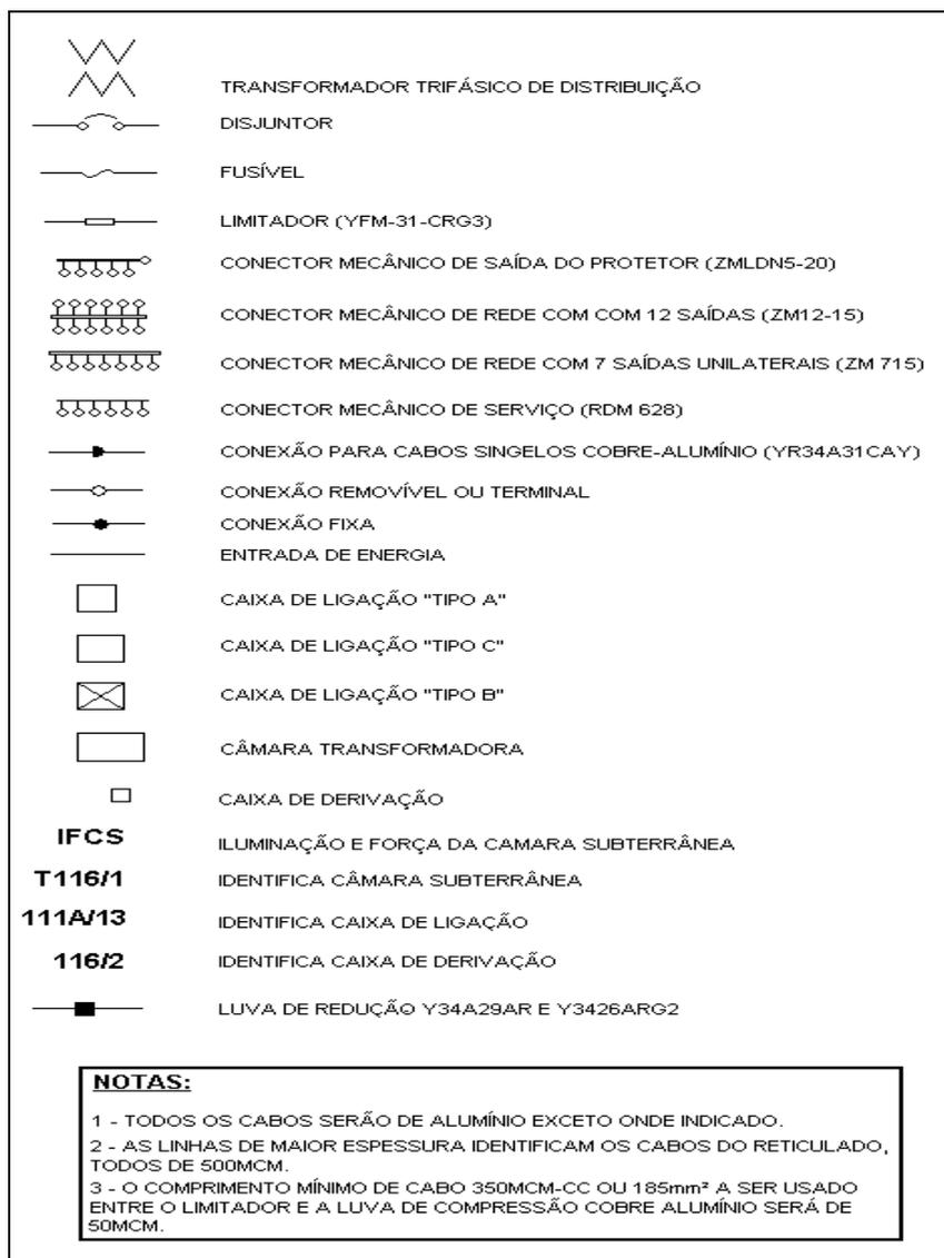
**Figura 21: Simbologia utilizada para graficação de redes subterrâneas. Fonte: Manual de Especificações para Fiscalização e Montagem Eletromecânica de Rede Subterrânea.**
