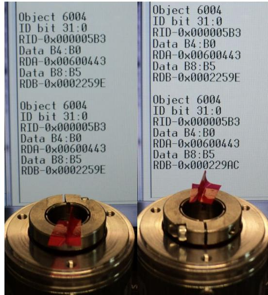
**Figura 5.2.4: Imagens do ensaio realizado com o *encoder*.**
