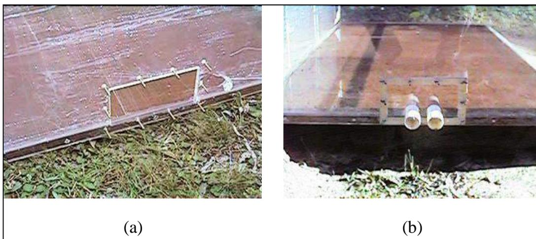
Figura 4.4 – Detalhes do encaixe das estruturas de descarga e descarregadores com  $2\phi 40\text{mm}$ .
