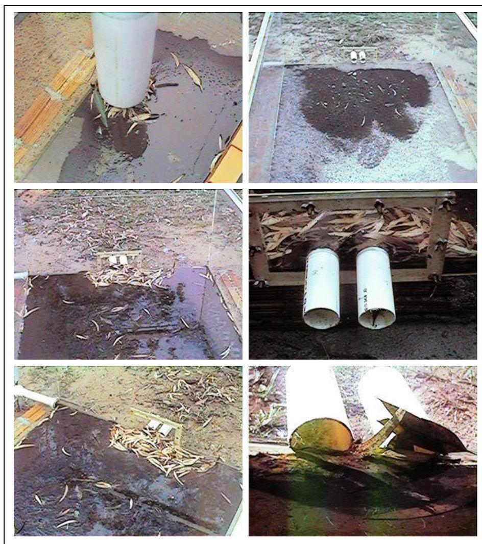
Figura 5.14 – Sedimentos e folhas no reservatório
