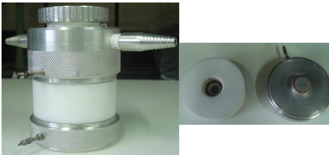
Figura 10 – Foto da célula termogalvânica com eletrodos em forma de rosca.
