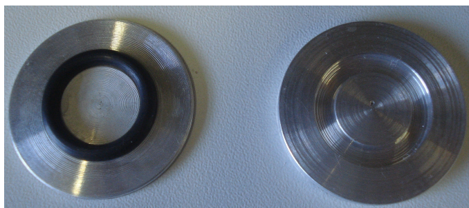
Figura 9 – Foto dos discos de alumínio puro utilizados como eletrodos na célula apresentada na Figura 8.
