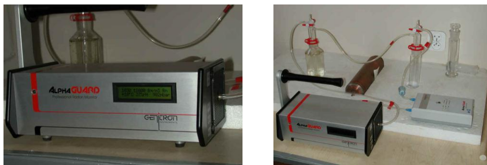
Figura 5 Foto do aparelho AlphaGUARD PQ2000PRO.
