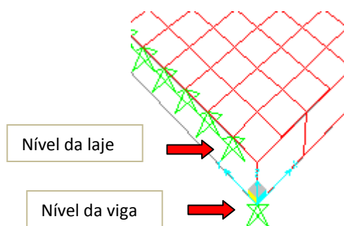
Figura 53 – Detalhe do apoio dos lados simplesmente apoiados
