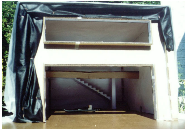
Figura 47 - vista externa da fachada da maquete da loja comercial e o piso fortemente iluminado pela penetração da luz do dia.
