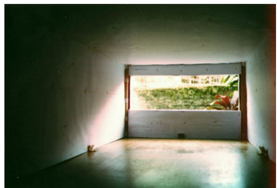
Figura 51 - vista interna da maquete da sala de escritório mostrando a zona de ofuscamento junto à abertura.
