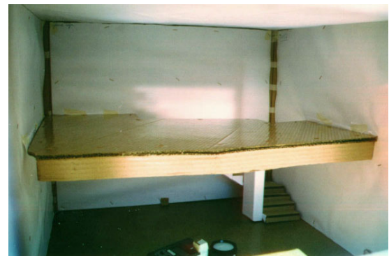
Figura 48 - vista interna da maquete da loja comercial e as áreas luminosas na parede do fundo sobre o mezanino criadas por refletância.
