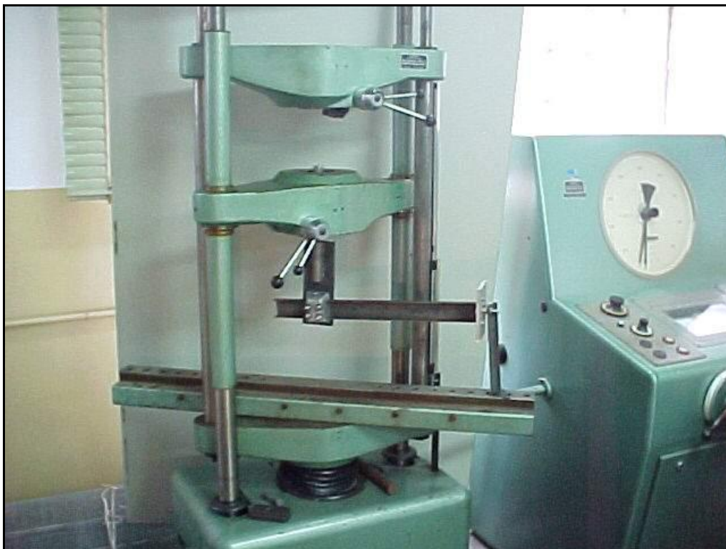
Figura 5-7 – Colapso da viga de 0,4m
