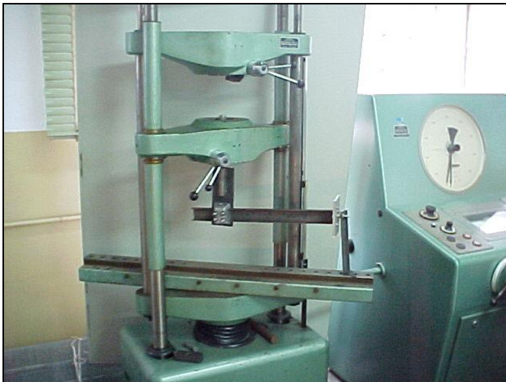
Figura 5-1 – Dispositivo para fixação da viga na máquina
