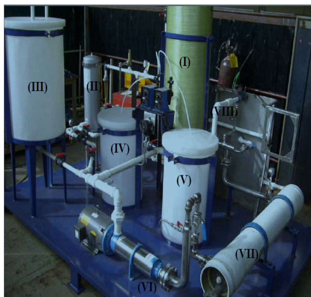
Figura 1: Vista frontal da unidade piloto de osmose inversa, onde (I) rotâmetro da alimentação, (II) microprocessador, (III) rotâmetro do reciclo, (IV) rotâmetro do concentrado, (V) microprocessador, (VI) filtro de areia e (VII) bomba de captação da torre.
