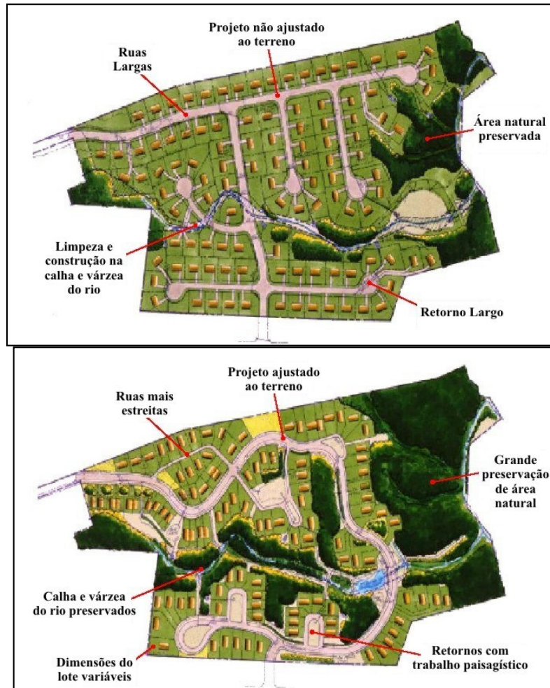
Figura 2.3. Diferença de planejamento da drenagem entre a técnica convencional e LID (Souza, 2005).
