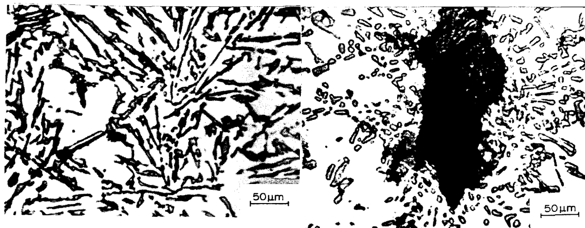
Figura 14: (a) Liga Al12Si não modificada, mostrando agulhas de Si com tamanho médio de 32\mu\text{m} . (b) Compósito Al12Si-3% grafite não modificado, mostrando cristais de Si com tamanho médio de 20\mu\text{m} . Ataque HF 5%, 200x [92].
