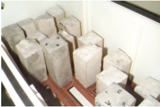
Figura 3 - Corpos-de-prova dispostos dentro da câmara, sobre o gabarito
