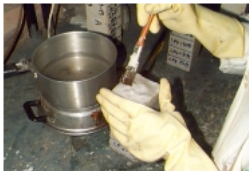
Figura 2 - Corpo-de-prova recebendo aplicação de parafina
