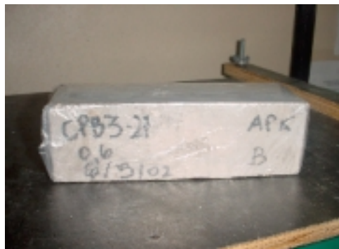
Figura 1 - Corpo-de-prova embalado para homogeneização
