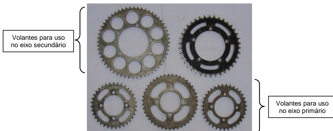
Figura 4.2 – Rodas dentadas adaptadas como volantes de inércia como meio de simulação de carga
