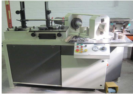
Figura 4.2 - Máquina extrusora para eletrodos revestidos do LS&TC.
