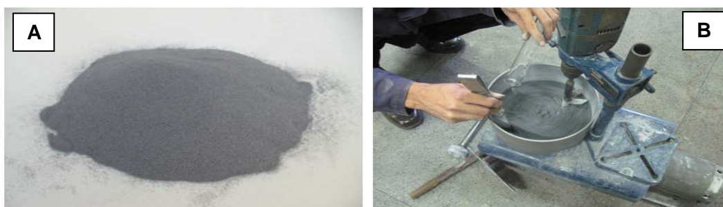
Figura 4.1 – (A) Matéria prima para o revestimento do eletrodo. (B) Processo de mistura.
