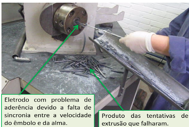
Figura 4.5 – Extrusão de eletrodo revestido na máquina do LS&TC.
