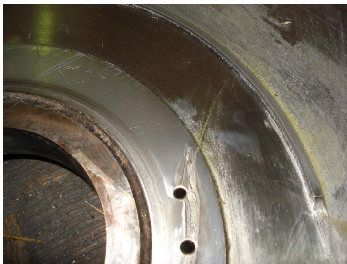
Figura 2.1 – Trincas apresentadas nos furos de lubrificação do último prato.
