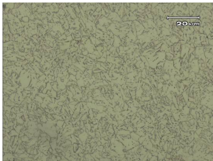
Figura 5.12 ZTA-PINO da amostra THX08. Ataque: Nital 2%. MO em 1000x.
