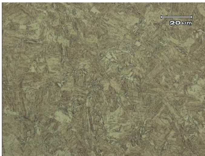
Figura 5.14 ZTA-MB da amostra THX08. Ataque: Nital 2%. MO em 1000x.
