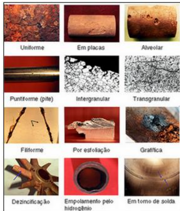
Figura 1: Formas de corrosão. (5)
