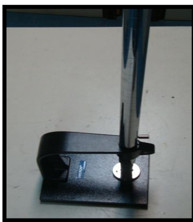
Figura 16. Equipamento para realização do ensaio de impacto.
