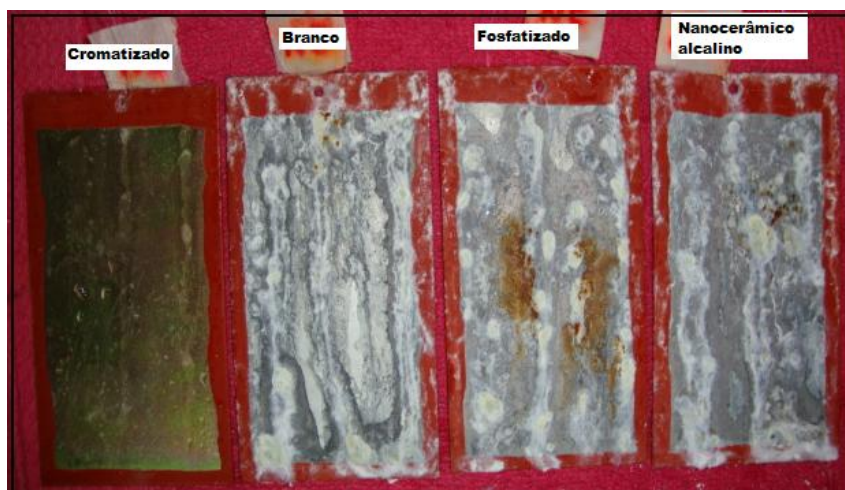
Figura 24. Amostras após 288 horas de exposição em Névoa Salina.
