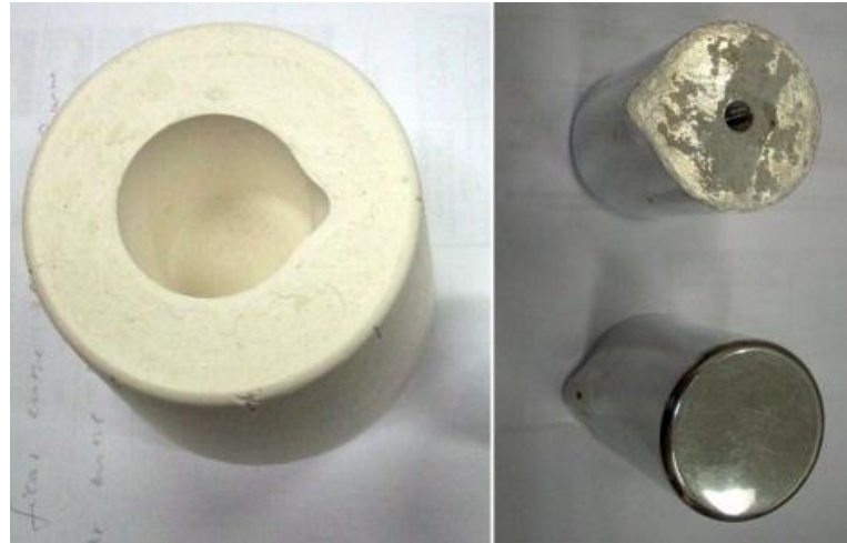
Figura 16 - Foto do molde de gesso utilizado na fabricação dos cadinhos (esq.) e do molde metálico utilizado na fabricação do molde de gesso (dir.).
