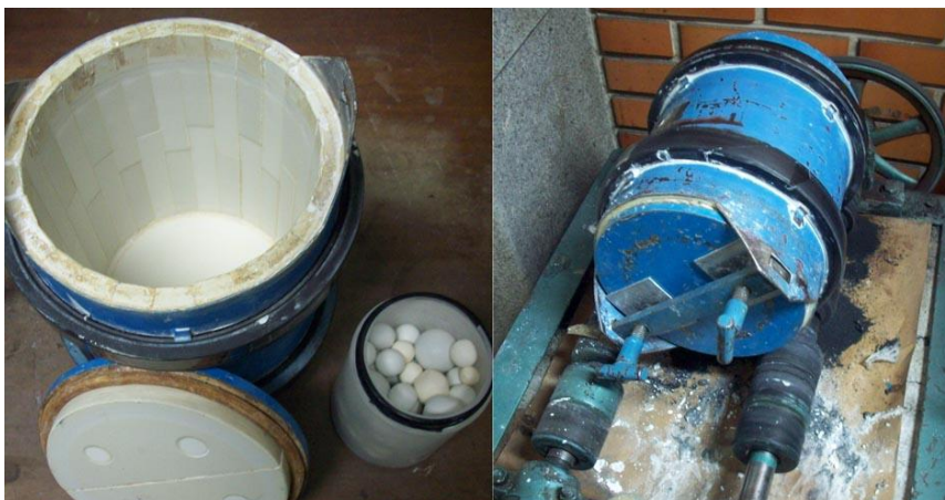
Figura 15 - Foto do moinho e bolas de alumina utilizadas na moagem dos pós de mulita e de mulita-zircônia.
