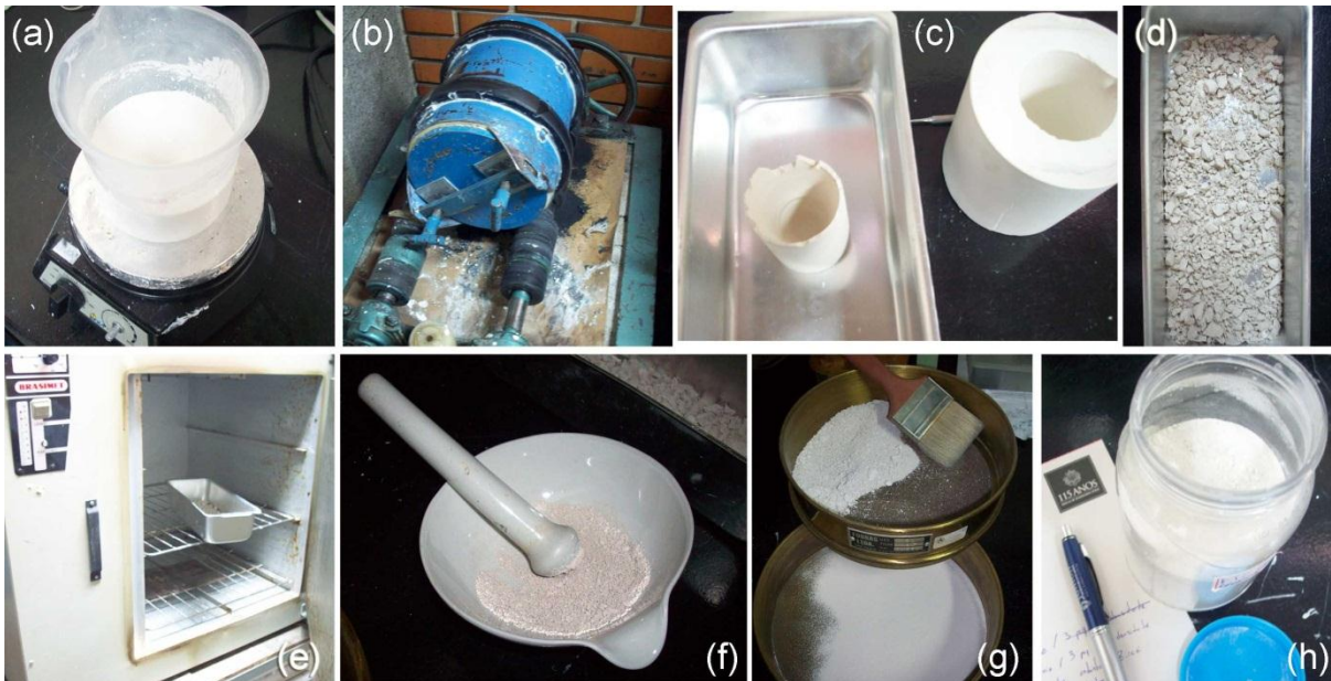
Figura 18 – O processo de obtenção do pó de prensagem para um pó cerâmico qualquer consistiu na (a) mistura do pó cerâmico + 3% (em peso de pó) de PVA (previamente diluído em água) + 50% (em peso de pó) de água deionizada, seguida pela (b) moagem (quando necessário) e homogeneização em moinho de bolas. A suspensão foi então (c) vazada em moldes de gesso para remover a água até formar um bloco de pó (peça a verde) para então (d) ser quebrado em pequenas pedras e colocado numa bandeja metálica que foi (e) levada para estufa a 50°C por algumas horas até o pó estar seco o suficiente para ser (f) moído com o graal e pistilo. Por último (g) os grãos secos e moídos foram peneirados em uma peneira MESH #60 e (h) a fração passante foi acondicionada ao abrigo da umidade.
