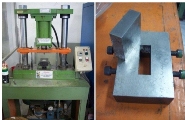
Figura 19 - Foto da prensa (esq.) e matriz (dir.) utilizada na conformação dos corpos de prova em forma de prismas.
