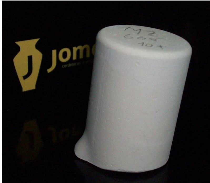
Figura 29 - Foto do cadinho de mulita-zircônia que não apresentou trincamento após 10 ciclos de choque térmico a 600°C.
