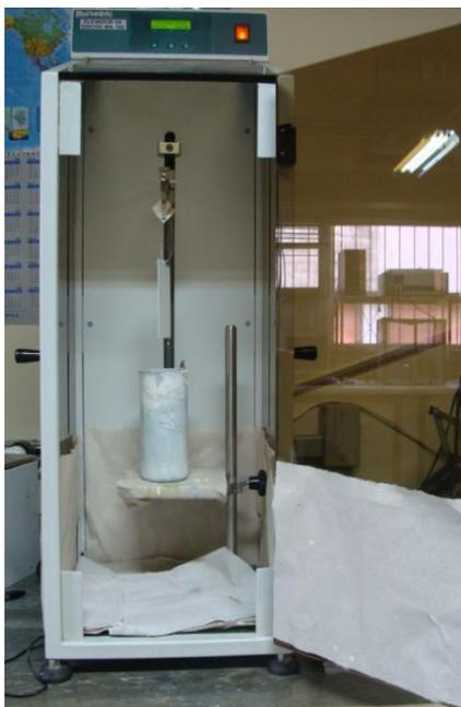
Figura 27 – Equipamento *Deep Coating Elevador de Disco MA 765-Marconi* utilizado para obtenção dos revestimentos com tinta nitrocelulose por *dip coat*.
