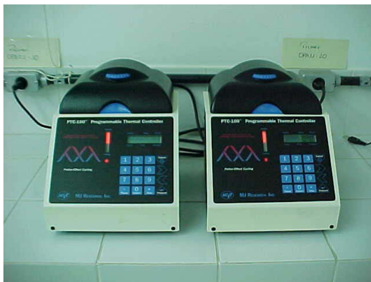
FIGURA 5 – Termocicladores PTC-100 ( Programmable Thermal Controller MJ Research, INC. ) utilizados para amplificação das seqüências de DNA.
