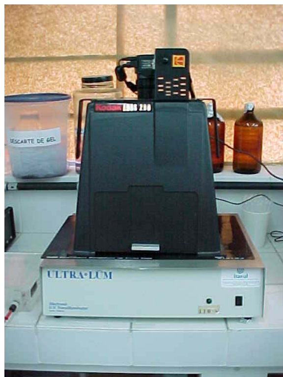
FIGURA 7 – Câmera digital adaptada ao transiluminador U.V..
