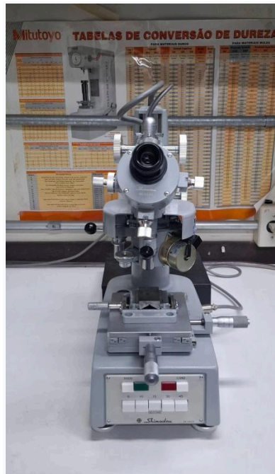
Figura 8. Durómetro Shimadzu Micro Hardness Tipo M.
