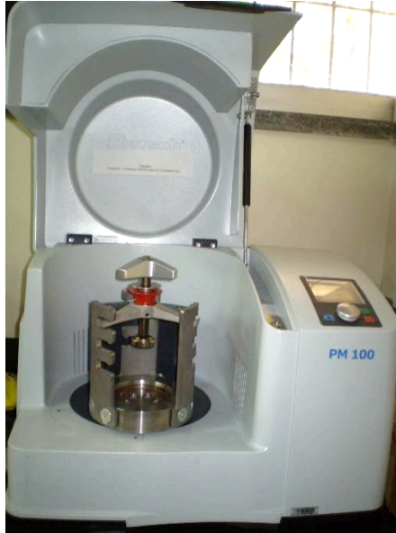
Figura 3. Molino Planetario de Bolas PM 100.
