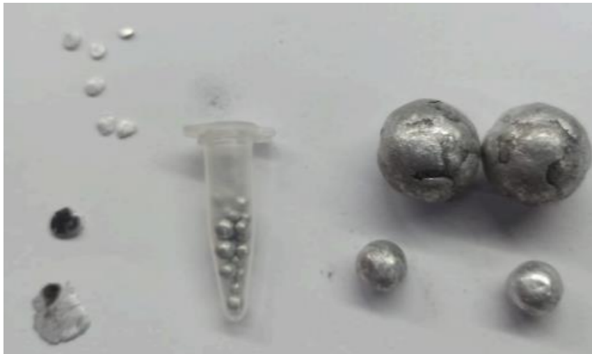
Figura 16. Peletización y soldadura en frío del proceso de AM durante 10 h.
