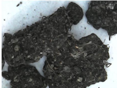
Figura A14 – Micrografias de microscopia óptica dos dispositivos com 35 dias de exposição ao solo. De cima para baixo e da esquerda para a direita: Calibração, P-S70G30-0U, P-S70G30-5U, P-S70G30-10U, P-S70G30-15U. É possível notar alterações evidentes nas superfícies, presença de partículas de solo aderidas e escurecimento generalizado de todas as amostras.
