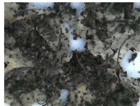
Figura A7 – Micrografias de microscopia óptica dos dispositivos com 20 dias de exposição ao solo. De cima para baixo e da esquerda para a direita: Calibração, P-S70D30-0U, P-S70D30-5U, P-S70D30-10U, P-S70D30-15U. É possível notar alterações evidentes nas superfícies, presença de partículas de solo aderidas e escurecimento generalizado de todas as amostras.
