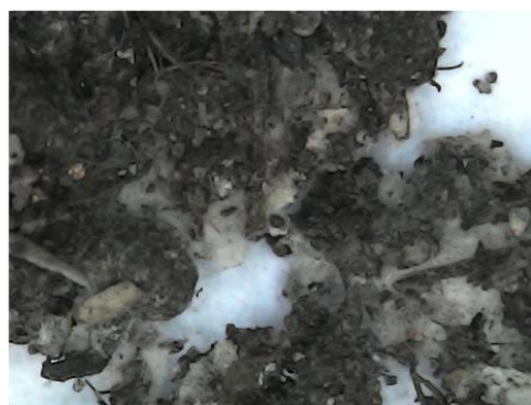
Figura A10 – Micrografias de microscopia óptica dos dispositivos com 25 dias de exposição ao solo. De cima para baixo e da esquerda para a direita: Calibração, P-S70G30-0U, P-S70G30-5U, P-S70G30-10U, P-S70G30-15U. É possível notar alterações evidentes nas superfícies, presença de partículas de solo aderidas e escurecimento generalizado de todas as amostras.
