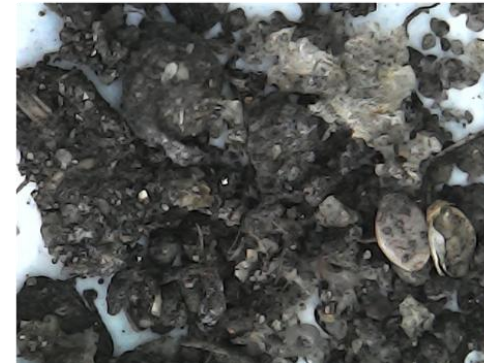
Figura A11 – Micrografias de microscopia óptica dos dispositivos com 30 dias de exposição ao solo. De cima para baixo e da esquerda para a direita: Calibração, P-S70D30-0U, P-S70D30-5U, P-S70D30-10U, P-S70D30-15U. É possível notar alterações evidentes nas superfícies, presença de partículas de solo aderidas e escurecimento generalizado de todas as amostras.
