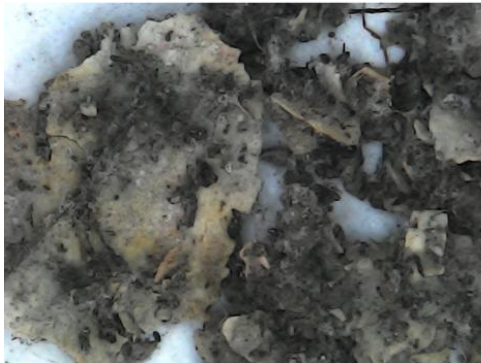
Figura A11 – Micrografias de microscopia óptica dos dispositivos com 30 dias de exposição ao solo. De cima para baixo e da esquerda para a direita: Calibração, P-S70D30-0U, P-S70D30-5U, P-S70D30-10U, P-S70D30-15U. É possível notar alterações evidentes nas superfícies, presença de partículas de solo aderidas e escurecimento generalizado de todas as amostras.
