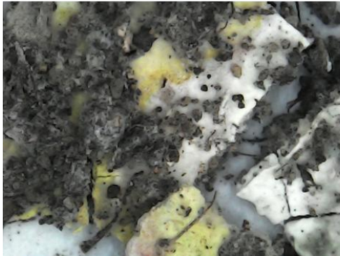
Figura A14 – Micrografias de microscopia óptica dos dispositivos com 35 dias de exposição ao solo. De cima para baixo e da esquerda para a direita: Calibração, P-S70G30-0U, P-S70G30-5U, P-S70G30-10U, P-S70G30-15U. É possível notar alterações evidentes nas superfícies, presença de partículas de solo aderidas e escurecimento generalizado de todas as amostras.
