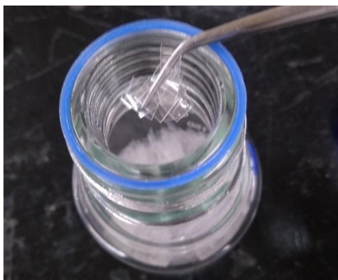
Figura 14 – Pedacos purificados de PET pós-consumo com dimensões de aproximadamente 0,6 cm 2 .
