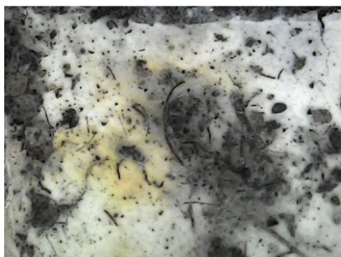
Figura A5 – Micrografias de microscopia óptica dos dispositivos com 15 dias de exposição ao solo. De cima para baixo e da esquerda para a direita: Calibração, P-S70D30-0U, P-S70D30-5U, P-S70D30-10U, P-S70D30-15U. É possível notar alterações evidentes nas superfícies, presença de partículas de solo aderidas e escurecimento generalizado de todas as amostras.
