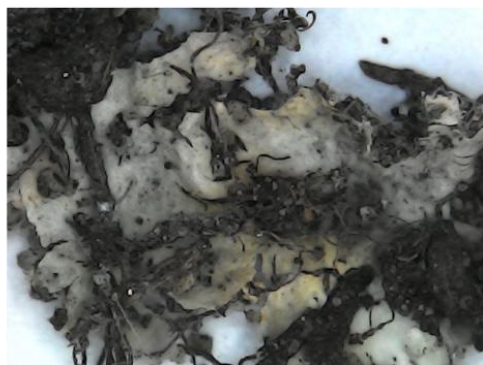
Figura A7 – Micrografias de microscopia óptica dos dispositivos com 20 dias de exposição ao solo. De cima para baixo e da esquerda para a direita: Calibração, P-S70D30-0U, P-S70D30-5U, P-S70D30-10U, P-S70D30-15U. É possível notar alterações evidentes nas superfícies, presença de partículas de solo aderidas e escurecimento generalizado de todas as amostras.
