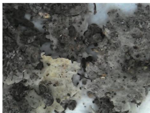
Figura A10 – Micrografias de microscopia óptica dos dispositivos com 25 dias de exposição ao solo. De cima para baixo e da esquerda para a direita: Calibração, P-S70G30-0U, P-S70G30-5U, P-S70G30-10U, P-S70G30-15U. É possível notar alterações evidentes nas superfícies, presença de partículas de solo aderidas e escurecimento generalizado de todas as amostras.
