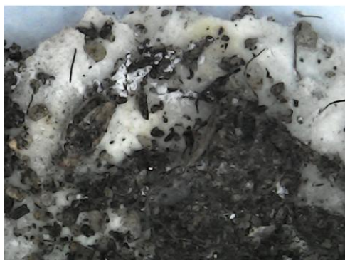
Figura A7 – Micrografias de microscopia óptica dos dispositivos com 20 dias de exposição ao solo. De cima para baixo e da esquerda para a direita: Calibração, P-S70D30-0U, P-S70D30-5U, P-S70D30-10U, P-S70D30-15U. É possível notar alterações evidentes nas superfícies, presença de partículas de solo aderidas e escurecimento generalizado de todas as amostras.
