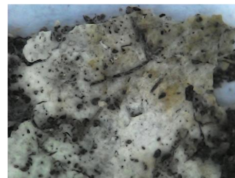
Figura A5 – Micrografias de microscopia óptica dos dispositivos com 15 dias de exposição ao solo. De cima para baixo e da esquerda para a direita: Calibração, P-S70D30-0U, P-S70D30-5U, P-S70D30-10U, P-S70D30-15U. É possível notar alterações evidentes nas superfícies, presença de partículas de solo aderidas e escurecimento generalizado de todas as amostras.
