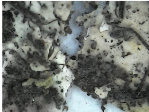
Figura A11 – Micrografias de microscopia óptica dos dispositivos com 30 dias de exposição ao solo. De cima para baixo e da esquerda para a direita: Calibração, P-S70D30-0U, P-S70D30-5U, P-S70D30-10U, P-S70D30-15U. É possível notar alterações evidentes nas superfícies, presença de partículas de solo aderidas e escurecimento generalizado de todas as amostras.
