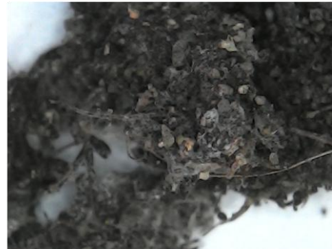
Figura A8 – Micrografias de microscopia óptica dos dispositivos com 20 dias de exposição ao solo. De cima para baixo e da esquerda para a direita: Calibração, P-S70G30-0U, P-S70G30-5U, P-S70G30-10U, P-S70G30-15U. É possível notar alterações evidentes nas superfícies, presença de partículas de solo aderidas e escurecimento generalizado de todas as amostras.
