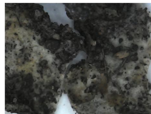
Figura A3 – Micrografias de microscopia óptica dos dispositivos com 10 dias de exposição ao solo. De cima para baixo e da esquerda para a direita: Calibração, P-S70D30-0U, P-S70D30-5U, P-S70D30-10U, P-S70D30-15U. É possível notar alterações evidentes nas superfícies, presença de partículas de solo aderidas e escurecimento generalizado de todas as amostras.
