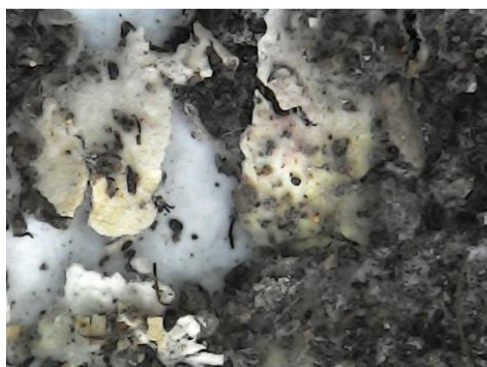
Figura A13 – Micrografias de microscopia óptica dos dispositivos com 35 dias de exposição ao solo. De cima para baixo e da esquerda para a direita: Calibração, P-S70D30-0U, P-S70D30-5U, P-S70D30-10U, P-S70D30-15U. É possível notar alterações evidentes nas superfícies, presença de partículas de solo aderidas e escurecimento generalizado de todas as amostras.
