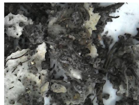
Figura A13 – Micrografias de microscopia óptica dos dispositivos com 35 dias de exposição ao solo. De cima para baixo e da esquerda para a direita: Calibração, P-S70D30-0U, P-S70D30-5U, P-S70D30-10U, P-S70D30-15U. É possível notar alterações evidentes nas superfícies, presença de partículas de solo aderidas e escurecimento generalizado de todas as amostras.
