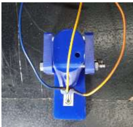
Figura 9: eletrodo e o suporte desenvolvido pela oficina da física para a leitura do eletrodo impresso.
