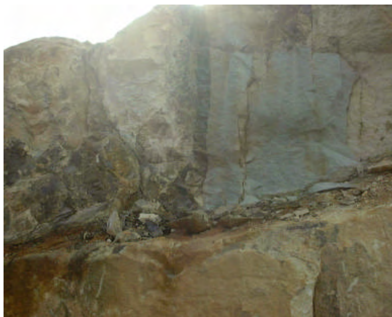
Fig. 76 - Frente de lavra de rocha ornamental em Tunas onde é evidente a alteração cromática do sienito pelo intemperismo. A rocha alterada encontra-se à direita do dique vertical visível na parte central da parede.
