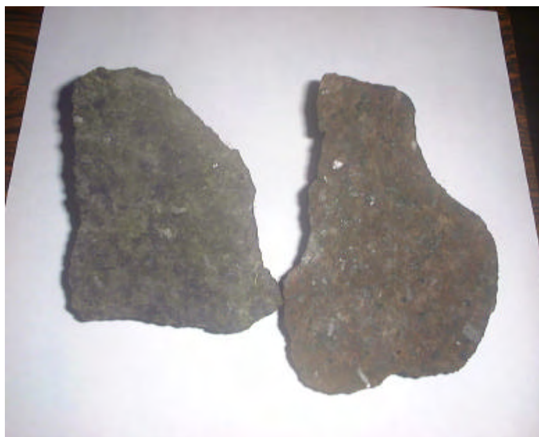
Fig. 74 - Resultado do tratamento térmico na amostra T32. À esquerda a amostra da mesma variedade de rocha antes do tratamento.
