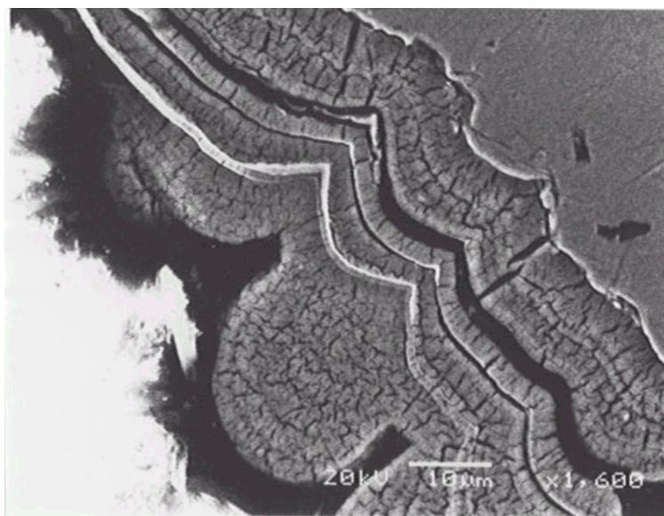
Figura 27. Imagem de elétrons secundários da seção transversal do depósito da liga Zn-Ni com 2,5 \text{ Adm}^{-2} , pH=6,2 . Aumento de 1600x.
