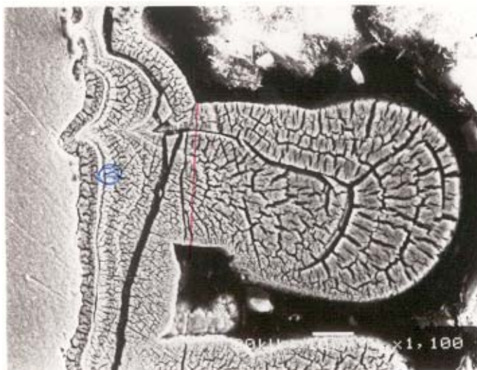
Figura 28. Imagem de elétrons secundários da seção transversal do depósito da liga Zn-Ni com 2,5 \text{ Adm}^{-2} com ânodos de zinco e níquel, \text{pH} = 6,2 . Aumento de 1100x
