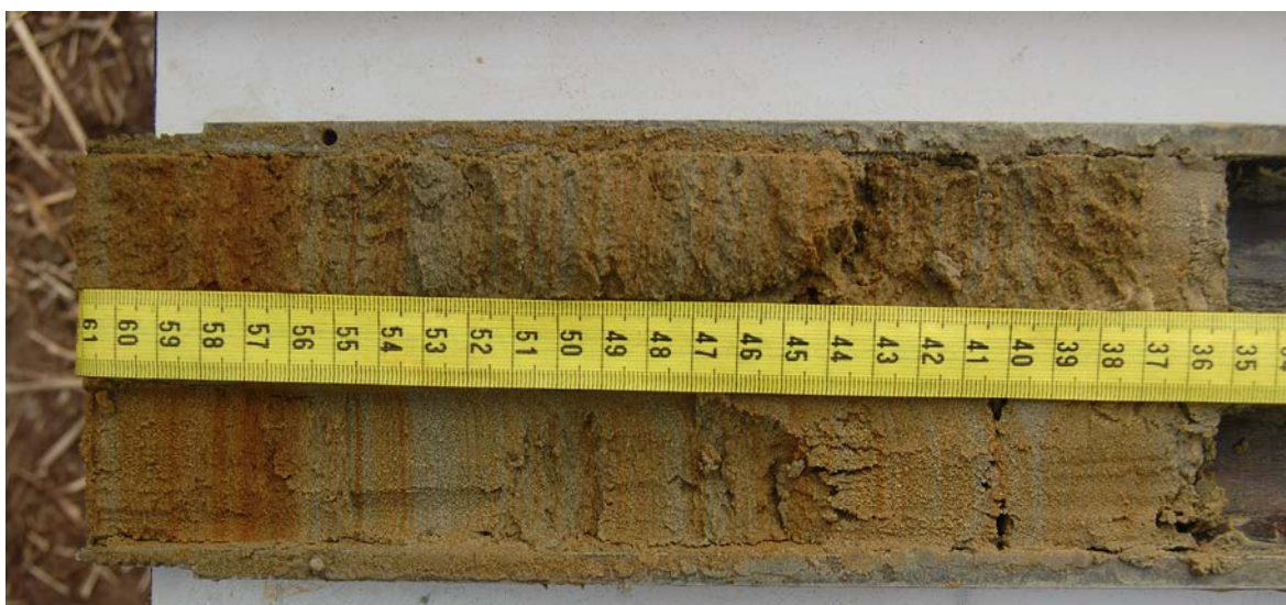
Figura 36: Fotografia da amostra correlacionada à perda do sinal de GPR. Nesta podemos observar laminações ferruginosas de oxidação.
