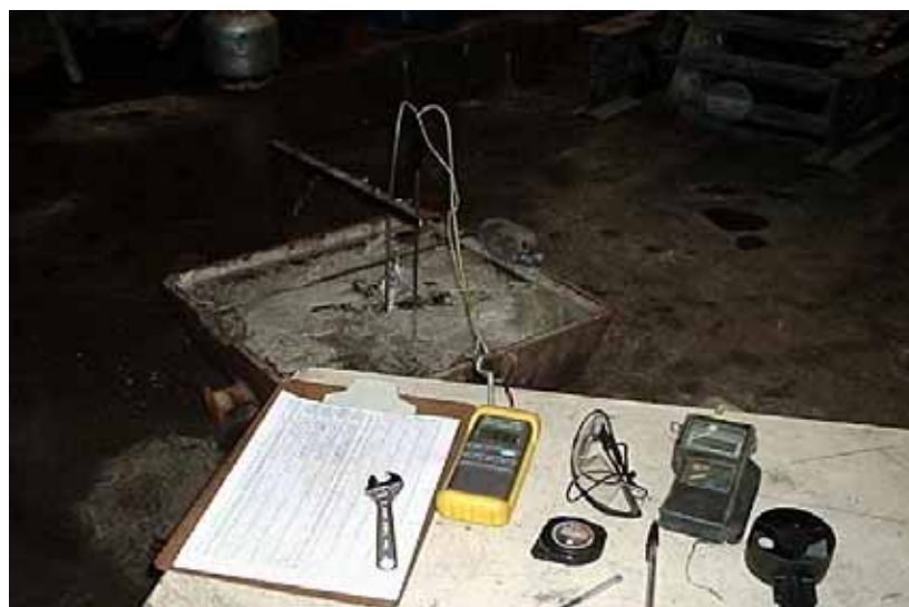
Fig. 4.1 Detalhe do aparato experimental da análise térmica resfriada naturalmente.
