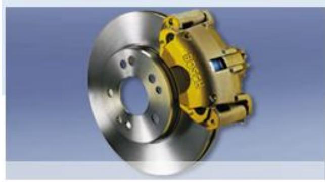
Figura 3.14 Freio a disco. Fonte: Bosch
