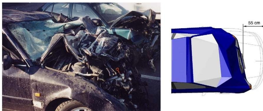
Figura 2.14 Danos causados no Audi A6, Balazic et al., 2006
