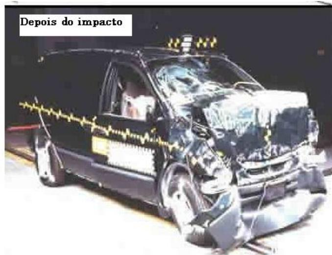
Figura 2.3 Teste de impacto frontal em barreira rígida. Fonte: Dodge
