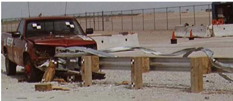
Figura 2.17 Danos causados em barreiras tipo “W” de proteção. Coon, 2006
