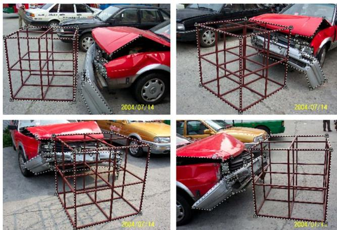
Figura 2.2 Deformação do veículo e sistema de referência, Du et al., 2009
