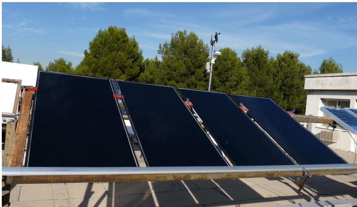
Figura 2.10 – Módulos de telureto de cádmio da empresa First Solar, modelo FS-272.
