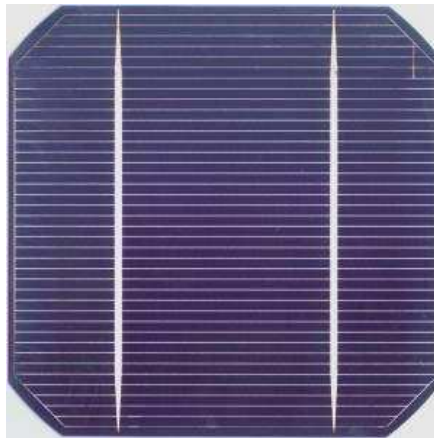
Figura 2.5 – Célula de silício monocristalino (Honsberg e Bowden, 2010).
