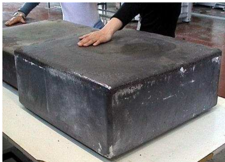
Figura 2.7 – Bloco de silício multicristalino, (Honsberg e Bowden, 2010)
