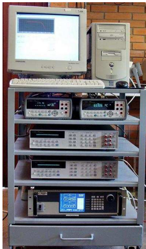
Figura 6.10 – Sistema para medida de curvas características de dispositivos fotovoltaicos utilizados no Labsol (Gasparin, 2009).
