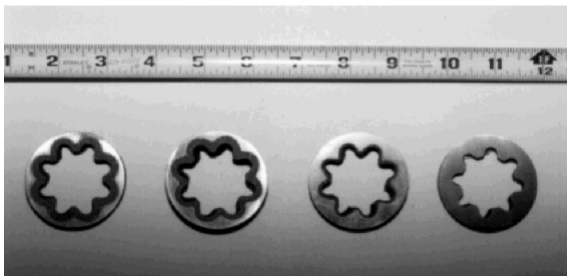
FIG. 88: Seções de um tubo HP40 atacado com áreas cementadas, reveladas por método químico.
