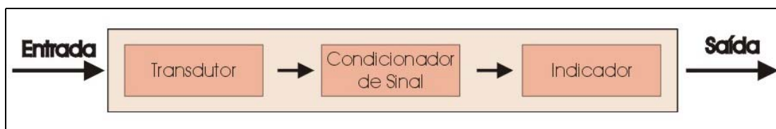
FIG. 10: Esquema geral de um sistema de medição
