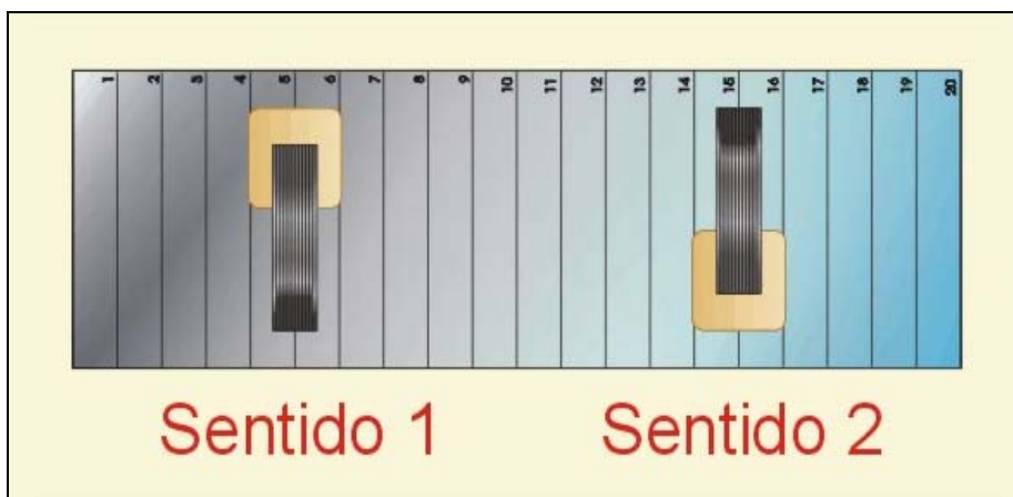
FIG. 70: Transdutor Magnético 13 sobre o gabarito no sentido 1 e 2
