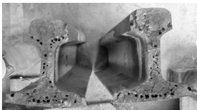
Figura 2.10 Soldas com forte porosidade (WTIA 2010).
