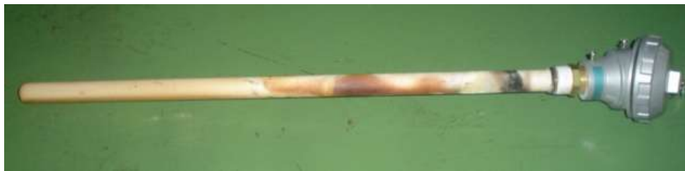
Figura 3.4 Sonda de carbono semelhante à usada no experimento.
