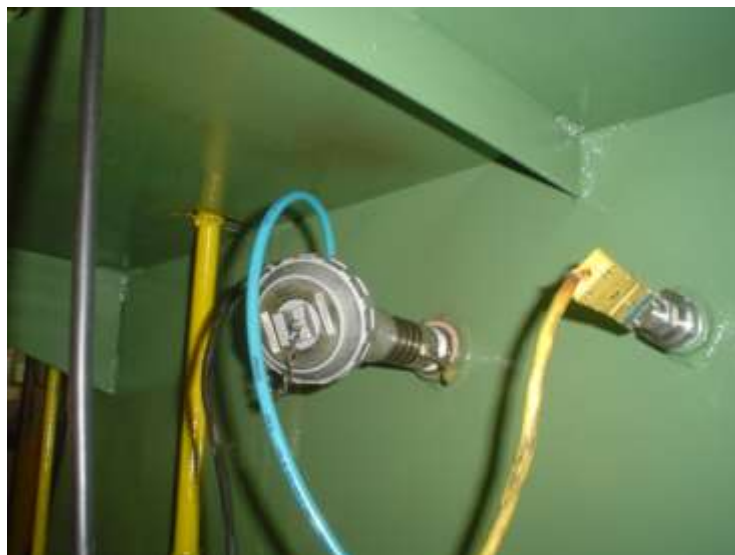
Figura 3.5 Sonda de carbono conectada ao forno de cementação.
