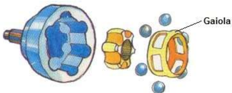
Figura 3.11 Junta fixa explodida, com a localização da gaiola. (Amortece Car 2008)
