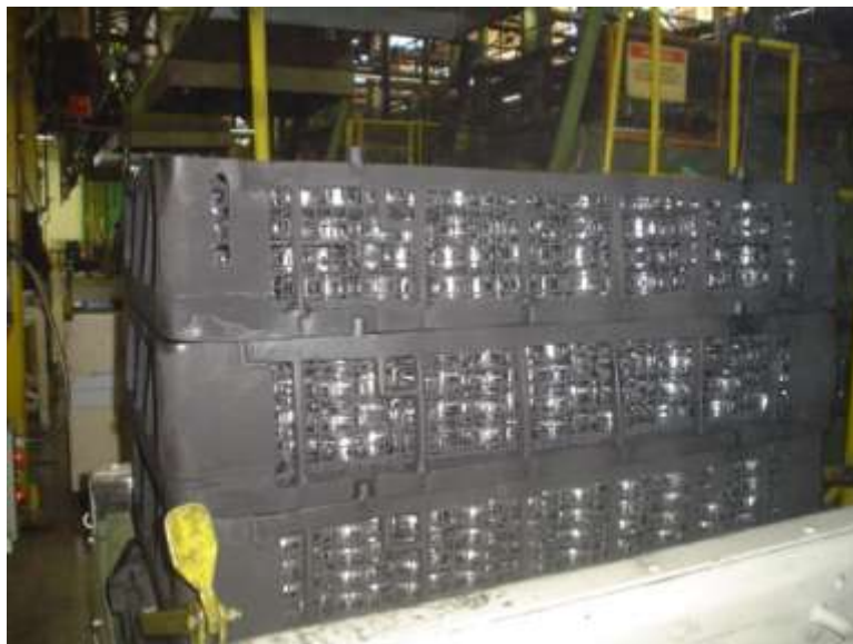
Figura 3.2 Carga montada em cestos, pronta para entrar no forno.
