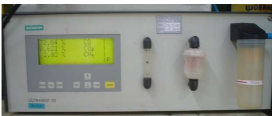
Figura 3.7 Analisador de gases por raios infravermelho.
