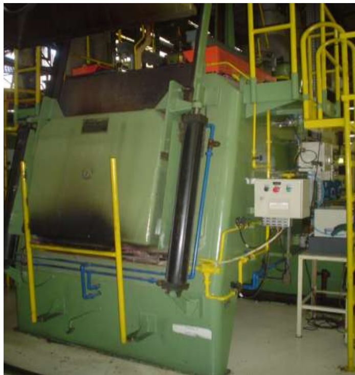
Figura 3.3 Forno de cementação da COMBUSTOL.
