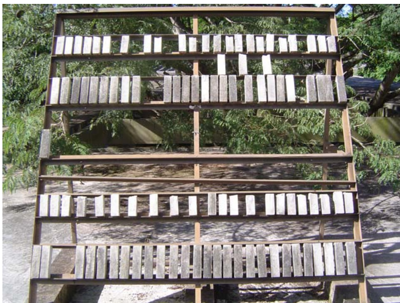
Figura 27 – Corpos-de-prova expostos em ambiente de ensaio natural externo (Ext U )
