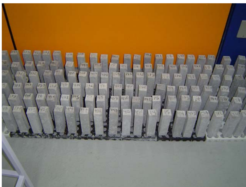
Figura 28 – Corpos-de-prova expostos em ambiente de ensaio natural interno (sala climatizada)
