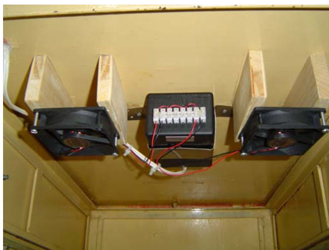
Figura 31 – Ventiladores da parte superior da câmara de 6% de CO 2
