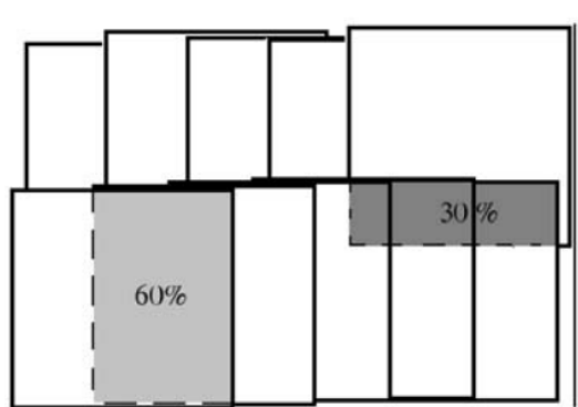
Figura 3. Exemplo de sobreposições lateral e longitudinal (BRITO; COELHO FILHO, 2007).
