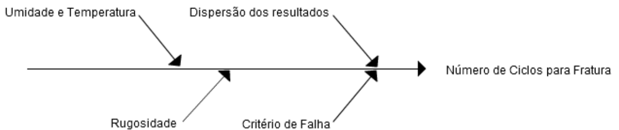
Figura 3.2: Diagrama de causa e efeito mostrando as possíveis fontes de incerteza para o número de ciclos para fratura em um ensaio de fadiga.
