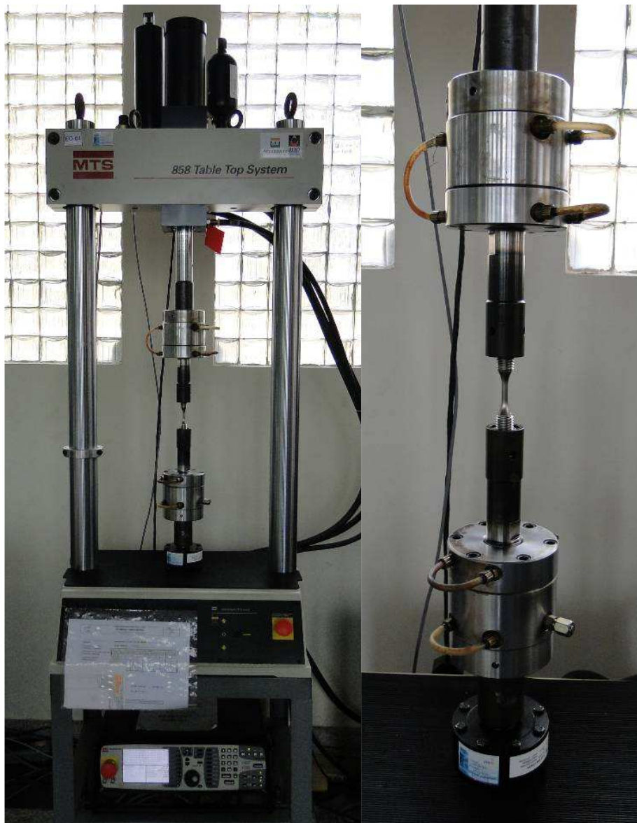
Figura 4.5: Máquina de ensaio utilizada e detalhe da fixação do corpo de prova.
