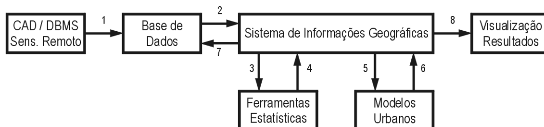
Figura 5.1 – Estrutura básica de um Sistema de Suporte ao Planejamento
