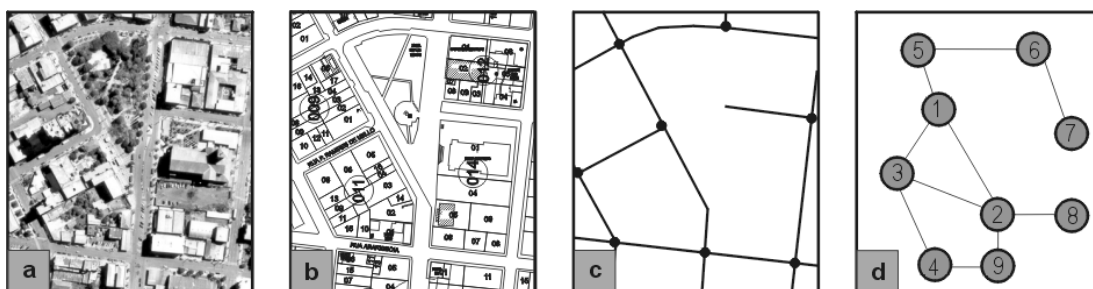
Figura 4.2 – Diferentes formas de representação de um sistema urbano: a) Aerofoto; b) Restituição Aerofotogramétrica; c) Trechos de logradouros; d) Grafos.
