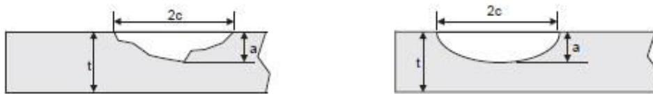
Figura 4.2: Recategorização de delaminação do tipo superficial.
