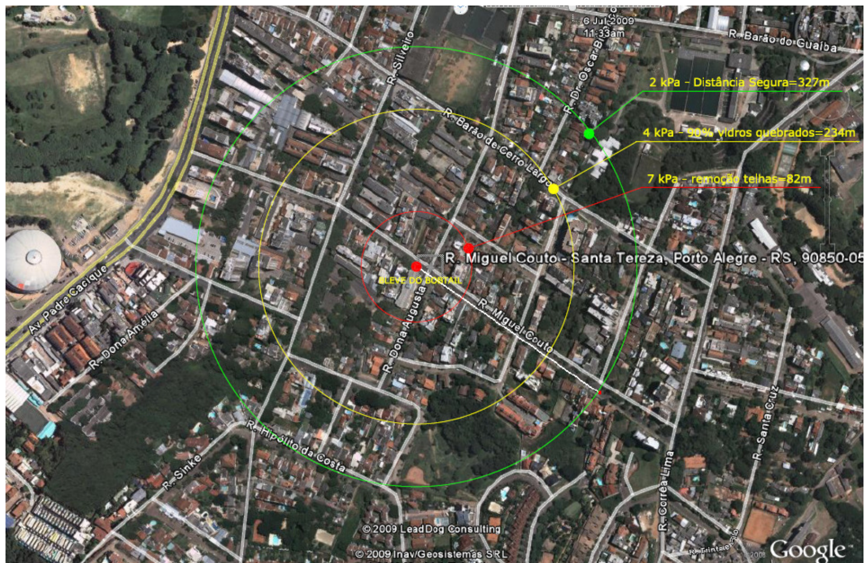
Figura 4.2 – Segunda Parte: Zonas de vulnerabilidade devido à sobrepessão gerada no BLEVE do Bobtail.
