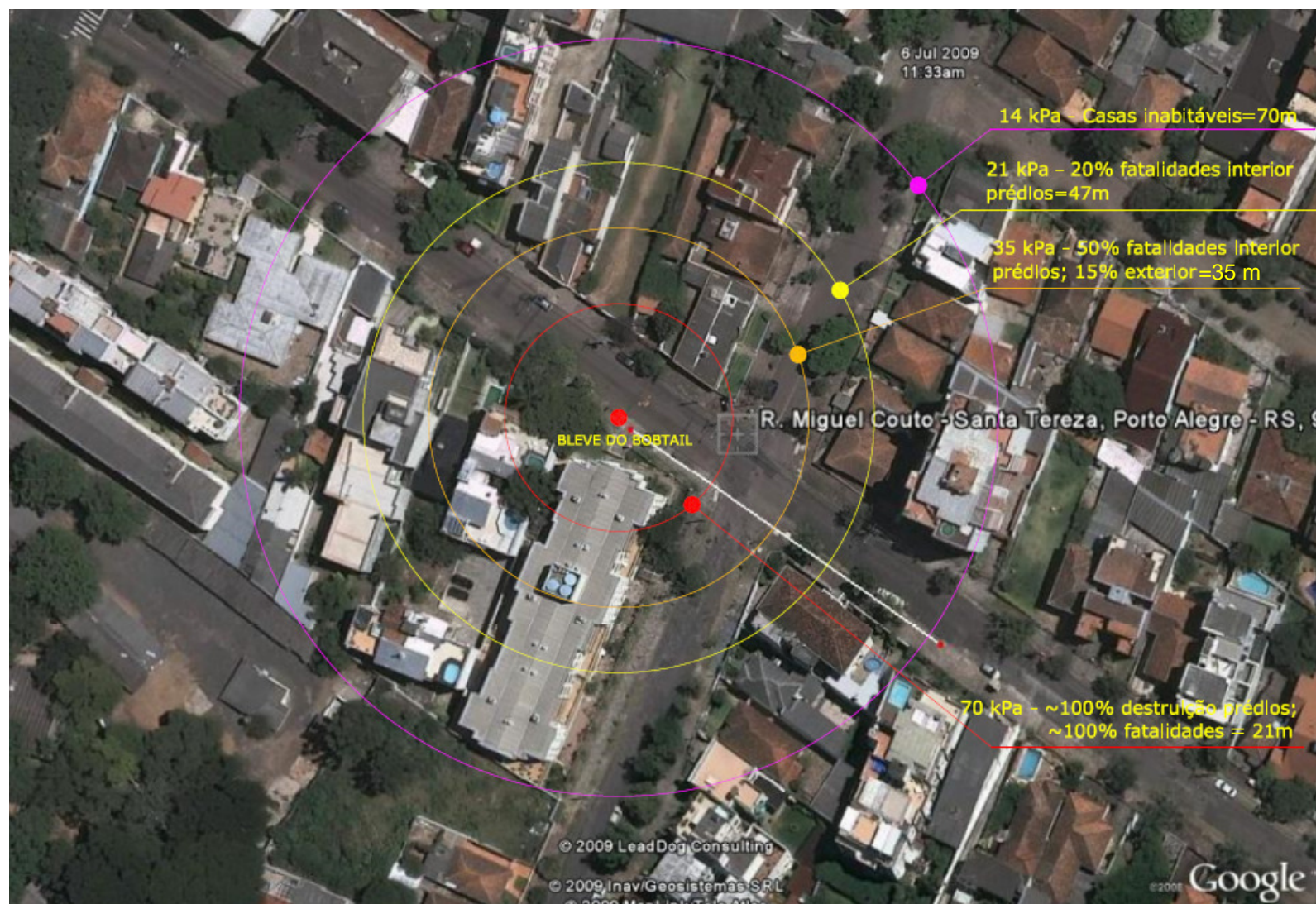
Figura 4.1 – Primeira Parte: Zonas de vulnerabilidade devido à sobrepressão gerada no BLEVE do Bobtail.
