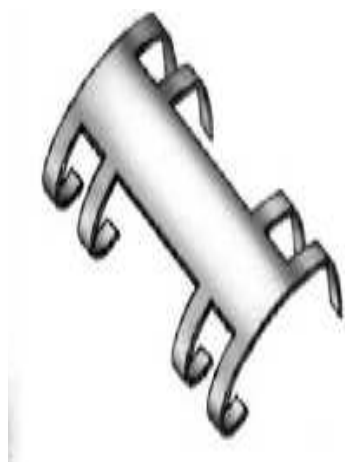
Figura 5 – Aspecto final da órtese de NiTi após aplicação de calor, demonstrando o arqueamento dos grampos.
