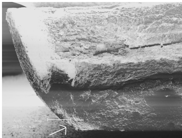
Figura 35: Nucleação de trinca na região do raio amostra 4.
