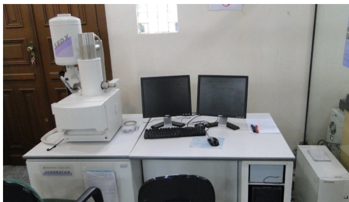
Figura 31: Equipamento utilizado para análise da fratura (Microscópio Eletrônico de Varredura).
