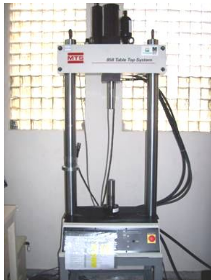
Figura 27: Equipamento servo hidráulico utilizado para realização dos ensaios.
