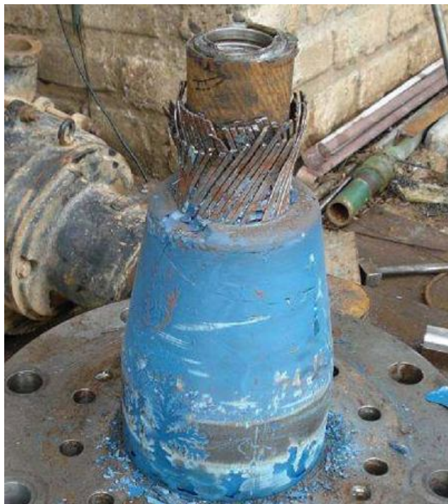
Figura 9: Detalhe das camadas de armadura de tração posicionadas em sentidos opostos [Bueno, 2010].
