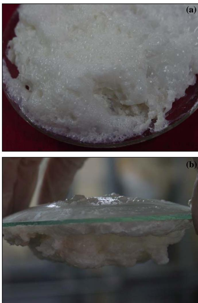
Figura 136. Fotografias do produto flotado gerado nos estudos floculação-flotação de partículas de caulim utilizando solução polimérica saturada para geração de microbolhas de ar. (a) vista de topo do material, (b) detalhe para a baixa umidade e elevada consistência de adesão do material.
