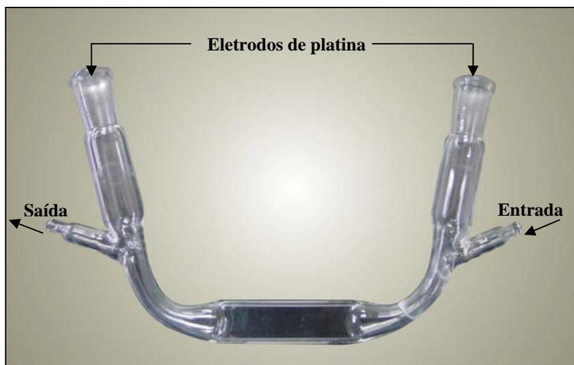
Figura 28. Fotografia da célula eletroforética modificada com dois tubos de vidro – Detalhe para as direções dos fluxos de microbolhas de ar e para a posição dos eletrodos.
