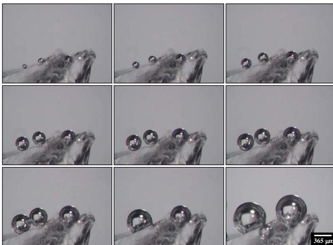
Figura 72. Imagens fotográficas dos fenômenos de nucleação seguidos de crescimento e coalescência de bolhas de ar sobre uma partícula de quartzo em água.
