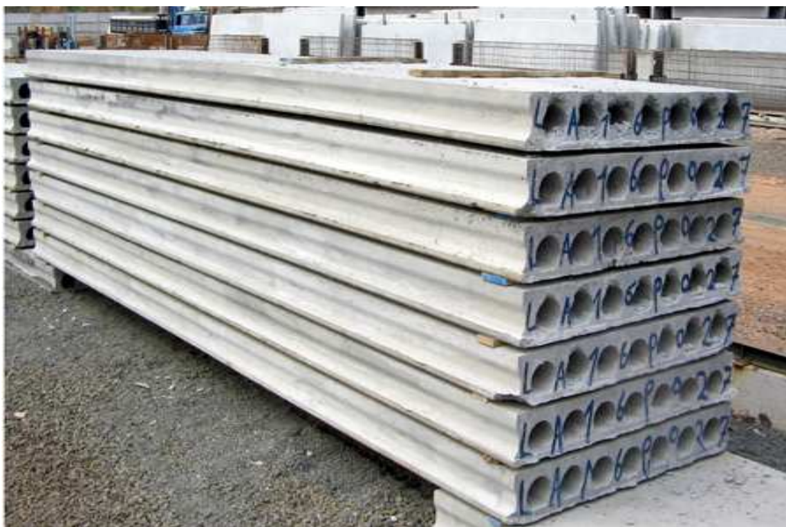
Figura 10 - Lajes alveolares protendidas, estocadas sobre calço de madeira
