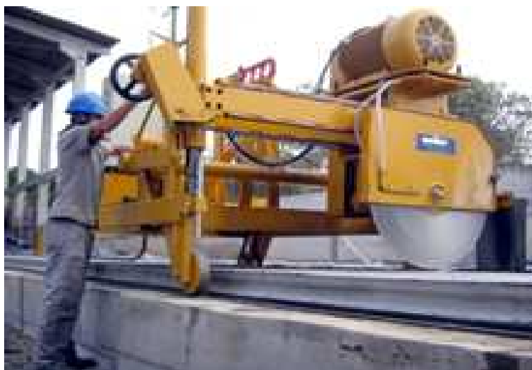
Figura 14 - Vista da máquina de corte da laje alveolar
