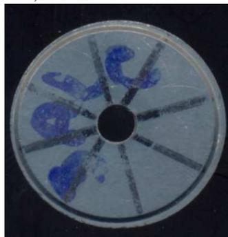
Pastilha de WC/Co com filme AlCrN de diâmetro final de 3,47 mm
