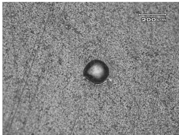
Figura 34 - Micrografias dos ensaios de Dureza Rockwell "A" (60 kgf) das amostras de WC/Co (fornecedor "A") com depósito de filmes finos de AlCrN
