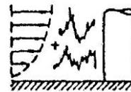
Figura 1. Exemplo de EIE ocasionada pelo martelamento turbulento (“*turbulent buffeting*”) do escoamento de aproximação sobre o cilindro (adaptado de Naudascher 1986).
