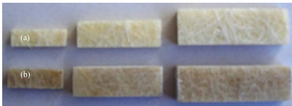
Figura 1: Corpos de prova com espessura de 3,15 mm ( L = 18,90 mm), 4,80 mm ( L = 28,80 mm) e 6,45 mm ( L = 38,70 mm), de compósitos com fibras de sisal (a) e curauá (b).
