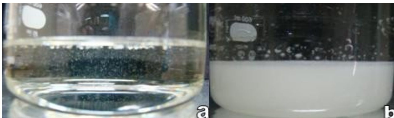
Figura 1 – Resina epóxi (a) antes e (b) depois da agitação mecânica forçada.
